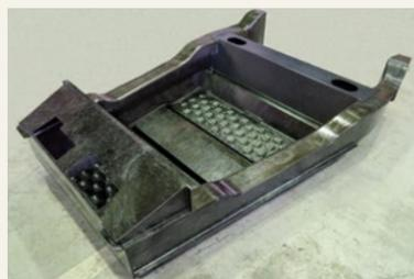
图2. LFT-D底盘结构
